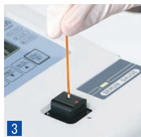
3 検体の入った毛細管を測定槽に挿入します
